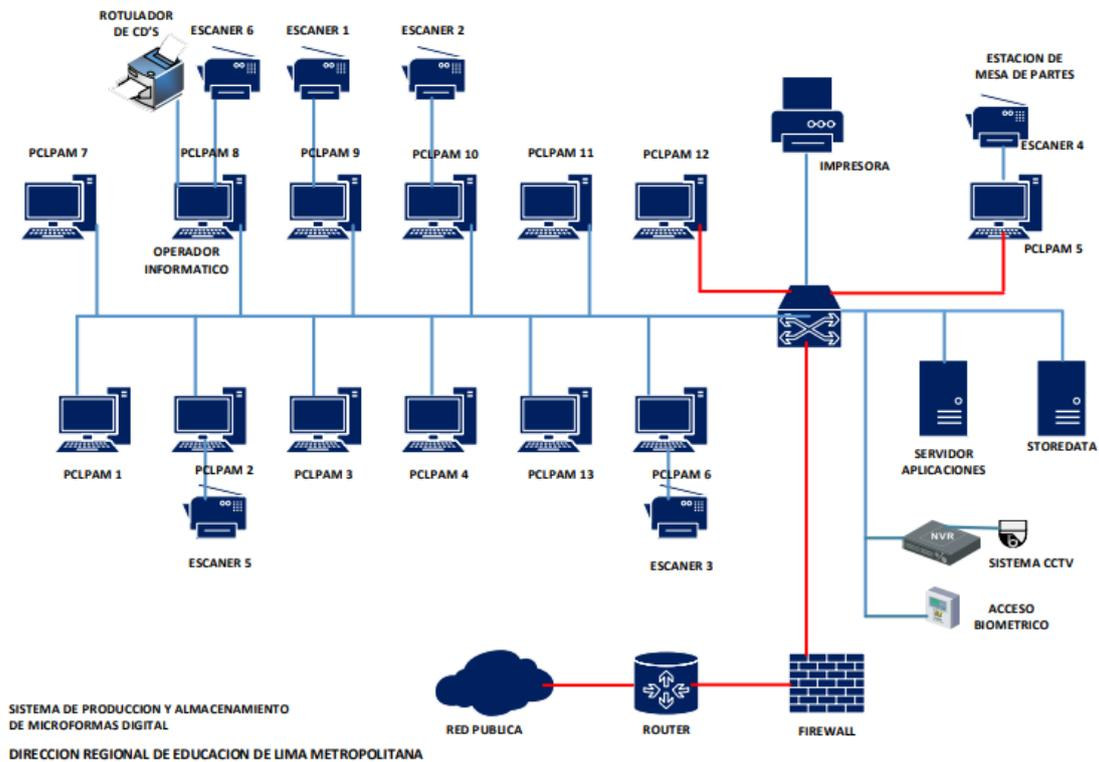
En este diagrama, la estación PCLPAM 5 es la estación de mesa de partes ubicada en un piso contiguo del mismo inmueble, pero con la misma conectividad que las demás estaciones porque se encuentra en el mismo esquema de red LAN diagramado. Desde esa estación se ponen a disposición de la línea central archivos electrónicos firmados digitalmente por un operador de mesa de partes. En tal sentido, no se trata de transmisión entre redes distintas. Todo está en la misma red LAN.
