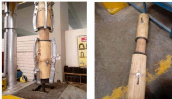
Foto 7: Ensayos de tracción en uniones colineales.
