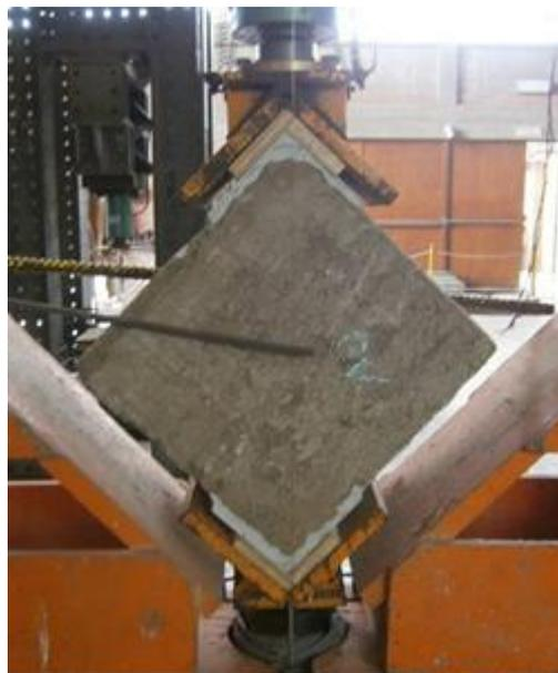
Figura 5.6. Especimen de ensayo a compresión diagonal.
