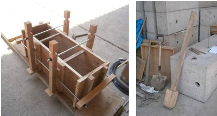
Figura 6.3. Molde de madera utilizado (izquierda) y pisón de madera (derecha).
