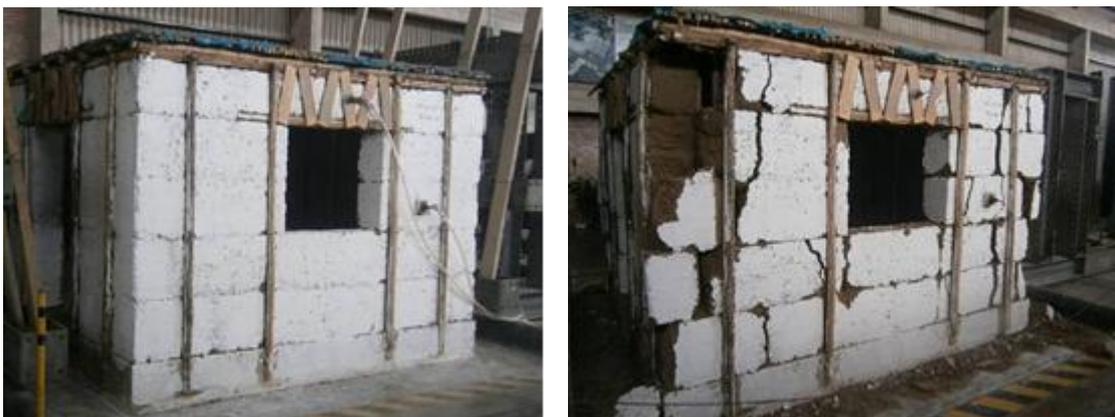
Figura 5.19. Módulo de tapial mejorado antes y después del ensayo.
