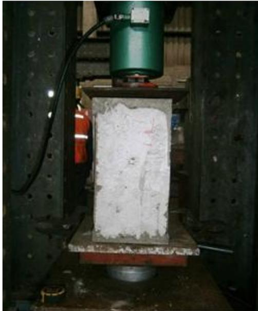
Figura 5.8. Espécimen de ensayo a compresión axial.
