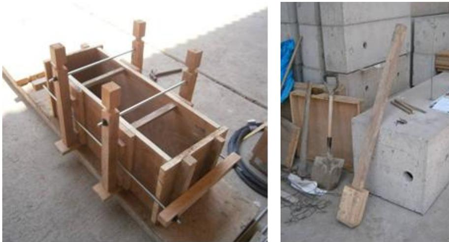
Figura 5.11. Molde de madera utilizado (izquierda) y pisón de madera (derecha)
