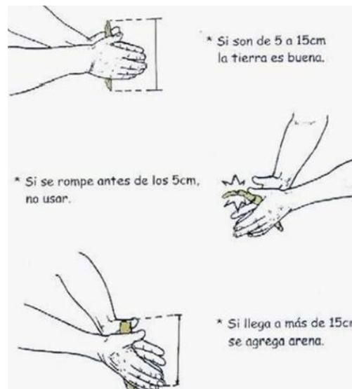
Figura 18. Proceso de fabricación del rollito.
