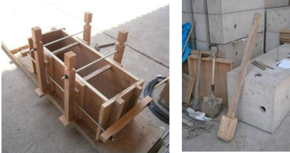
Figura 5.11. Molde de madera utilizado (Izquierda) y pisón de madera (Derecha)
