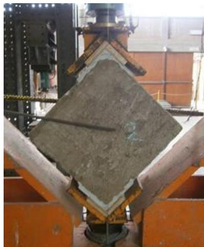
Figura 5.6. Espécimen de ensayo a compresión diagonal.
