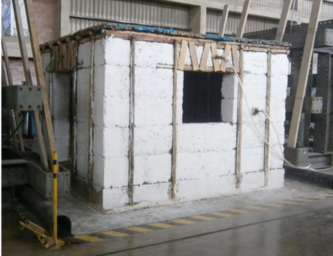
Figura 6.11. Módulo terminado y colocado en la plataforma de ensayo.
