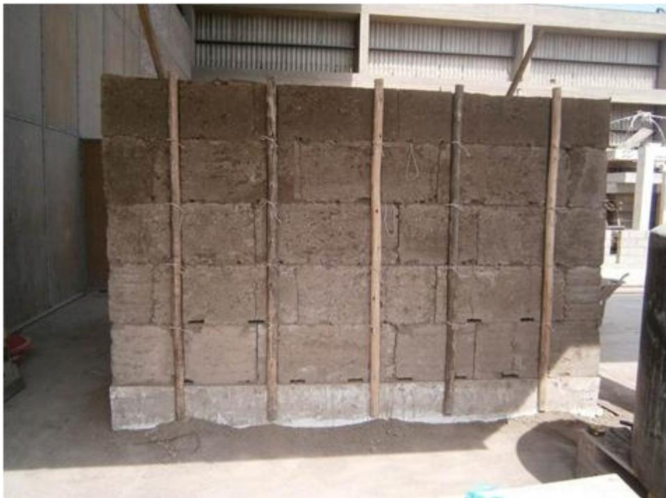
Figura 2.10. Distribución del refuerzo exterior.
