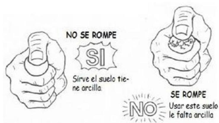
Figura 16. Ruptura de la bola.
