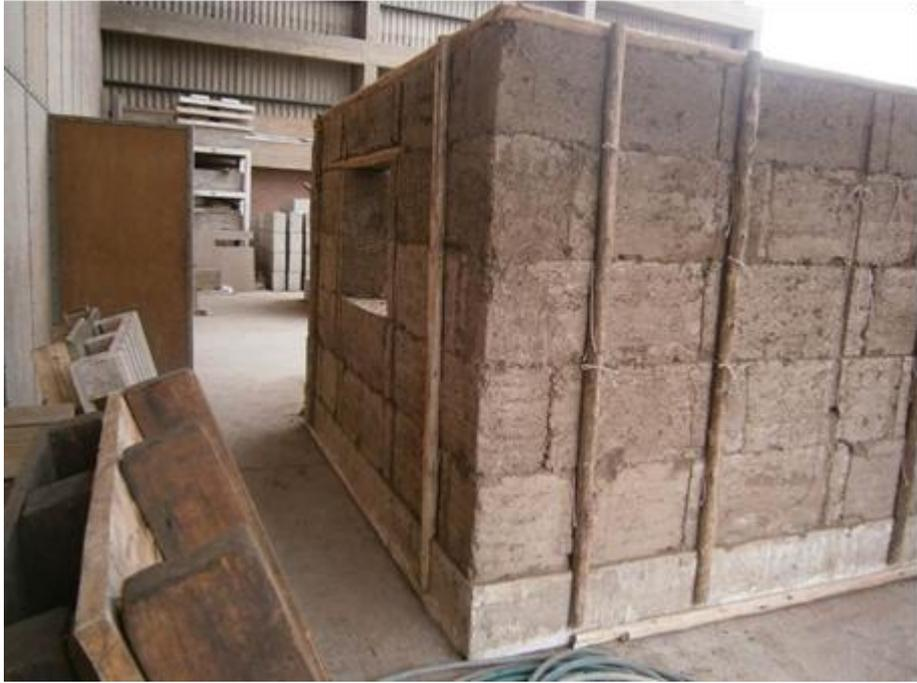
Figura 2.11. Distribución del refuerzo exterior.
