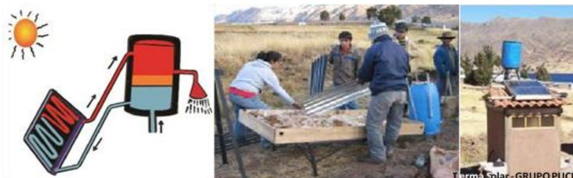
El colector solar es la superficie donde se produce la absorción de energía, dónde se calienta y se transfiere el calor al agua. Un colector de 1m<sup>2</sup> de superficie calienta aprox. 30 litros de agua a 60°C cada día. El costo aproximado es de S/.2000.
