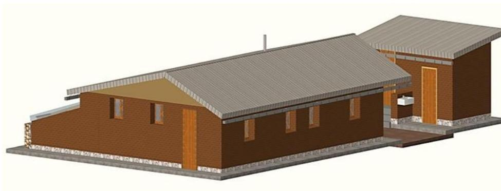
Los materiales recomendados para esta zona de la vivienda son la madera para la estructura de los techos, rellenos de y paja, cobertura de planchas onduladas o tejas. Muros de adobe con estructuras de carrizo o refuerzo de geomalla, viga collar y sobrecimientos de piedra. Pisos con base de piedras y tabloncillos de madera sobre durmientes, que permitan aislar la humedad del suelo y crear una cámara de aire entre el piso y el acabado final.
