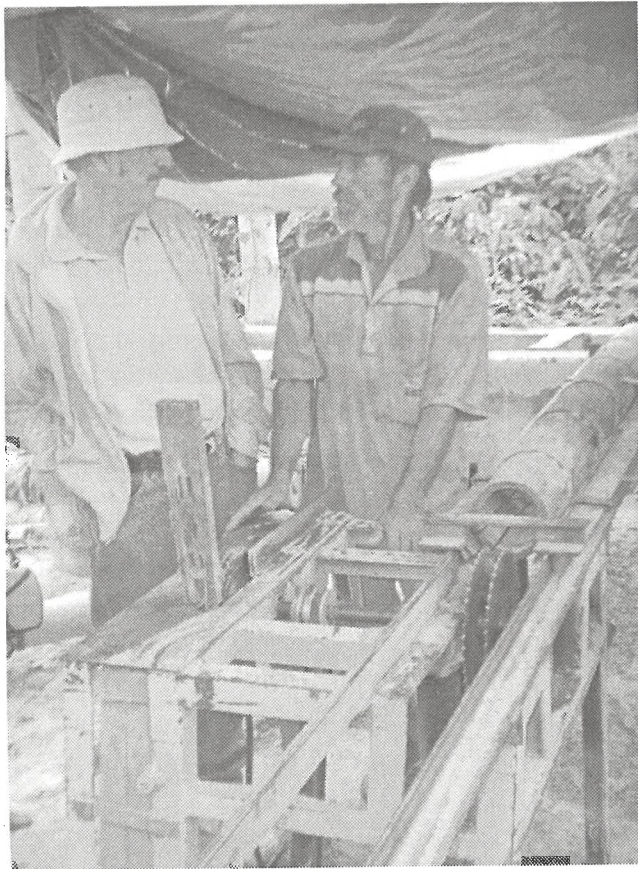
Cortadora de "listones" de bambú o "latas".
