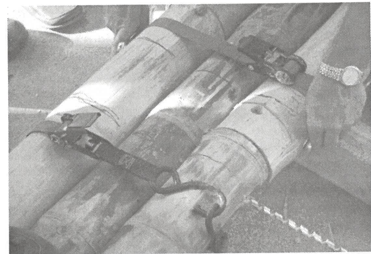
Sujeción y perforación de bambús
