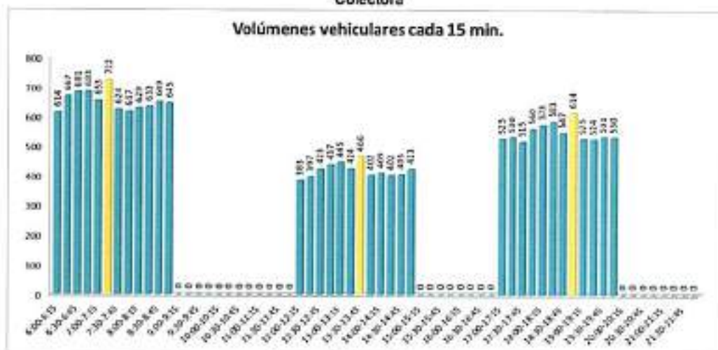
Identificación del intervalo de Máxima Demanda Vehicular en la intersección Av. Metropolitana– Av. Colectora
