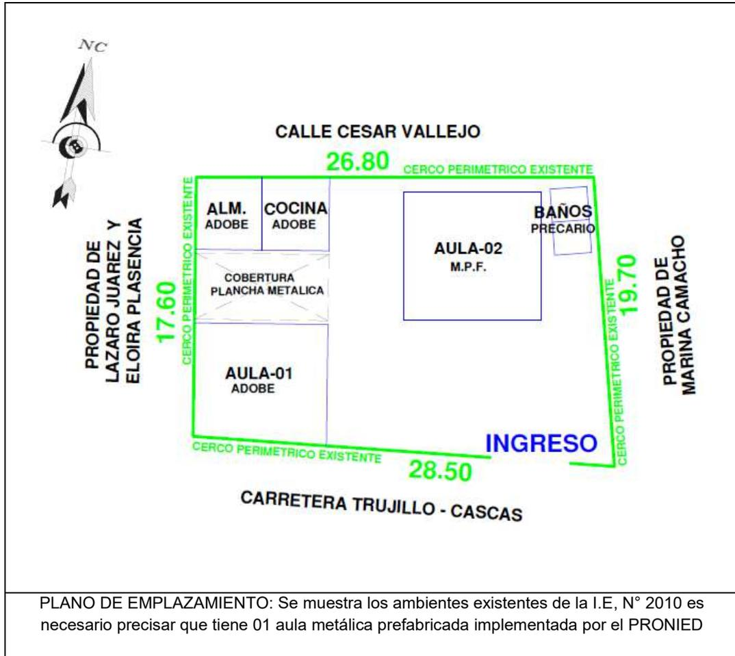
PLANO DE EMPLAZAMIENTO: Se muestra los ambientes existentes de la I.E, N° 2010 es necesario precisar que tiene 01 aula metálica prefabricada implementada por el PRONIED
