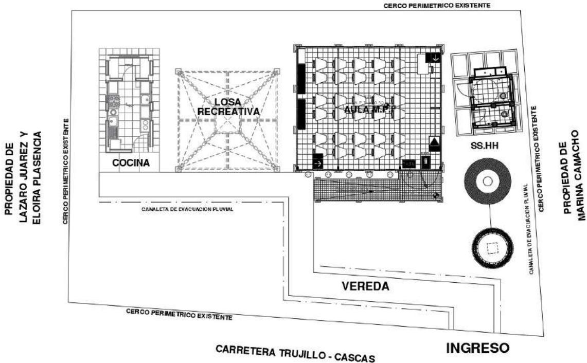
**PLANO DE INTERVENCIÓN:** Se intervendrá la I.E. con un 01 Losa Recreativa, 01 Módulo de cocina, vereda de concreto, canal de evacuación de aguas pluviales. La intervención también contempla trabajos de redes de agua, de desagüe, conexiones eléctricas y la demolición de ambientes por encontrarse en mal estado (tal como se pone de manifiesto en el informe de diagnóstico y metas del presente documento).
