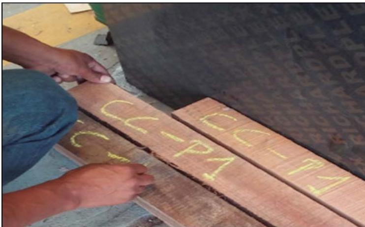
Figura 10: Probetas de madera del tipo Cachimbo Colorado
