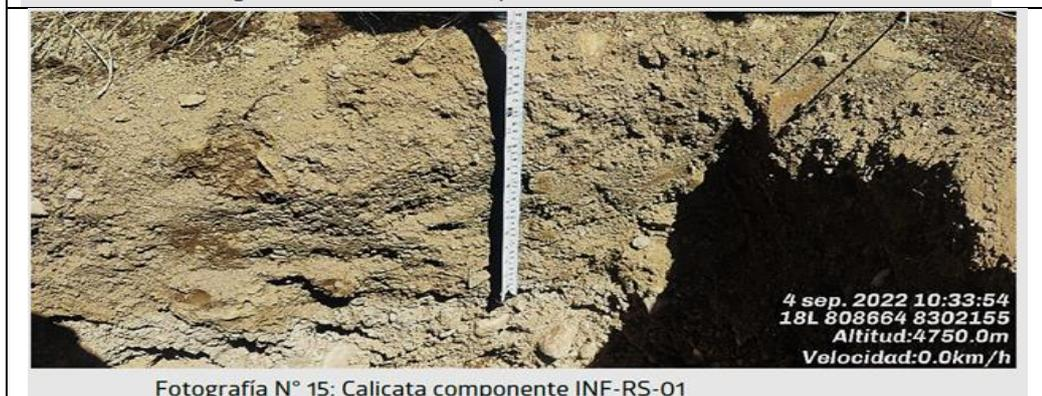
Fotografía N° 15: Calicata componente INF-RS-01
