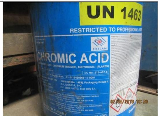
**Fotografía: IMG\_ 4706.** Vista de envase en desuso de ácido crómico, indicándose la peligrosidad debido a sus características de inflamabilidad y toxicidad.
