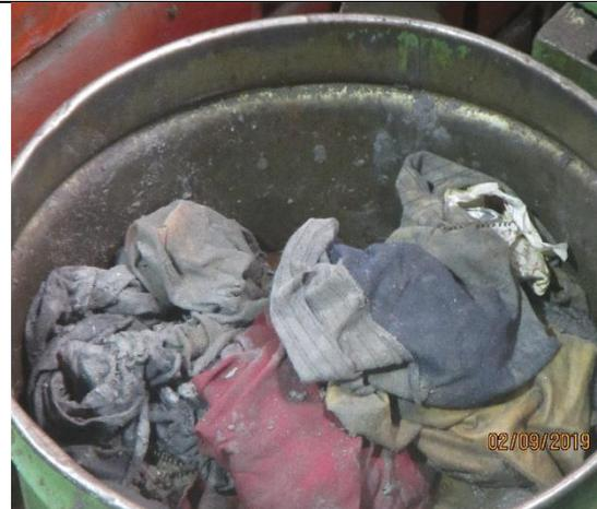
**Fotografía: IMG\_ 4654.** Vista de trapos impregnados con grasas y aceites en contenedor no rotulado.
