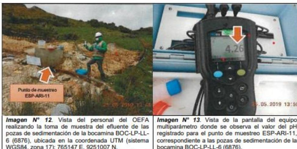
**Imagen N° 12.** Vista del personal del OEFA realizando la toma de muestra del efluente de las pozas de sedimentación de la bocamina BOC-LP-LL-6 (6876), ubicada en la coordenada UTM (sistema WGS84, zona 17): 765147 E, 9251007 N.
