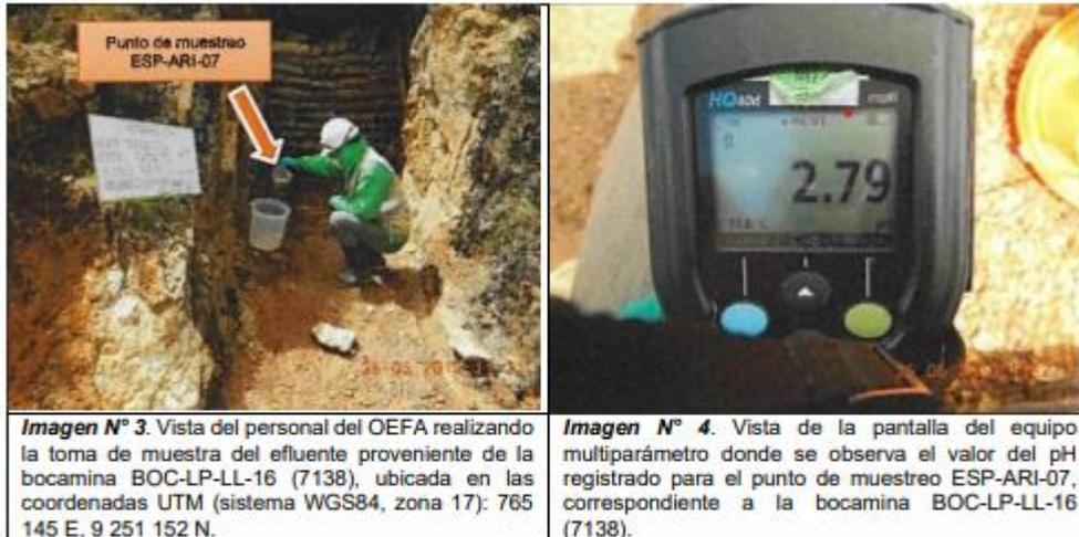
**Imagen N° 3.** Vista del personal del OEFA realizando la toma de muestra del efluente proveniente de la bocamina BOC-LP-LL-16 (7138), ubicada en las coordenadas UTM (sistema WGS84, zona 17): 765 145 E, 9 251 152 N.
