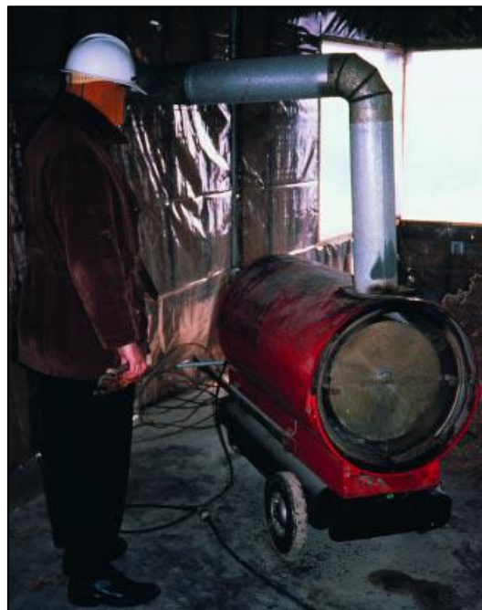
Figura 29: Calefactor de flama (PCA)
