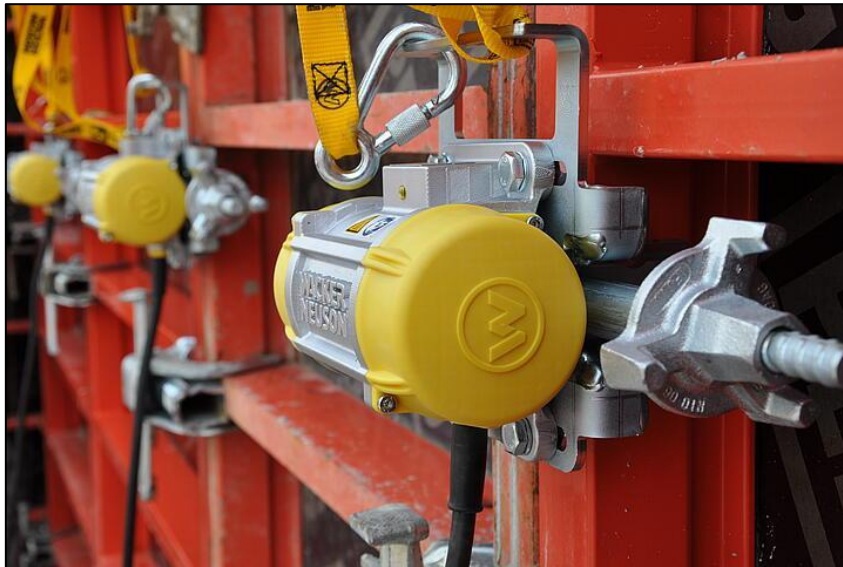
Figura 14: Vibrador externo en encofrados (Fuente: Pag. Web BEKA)
