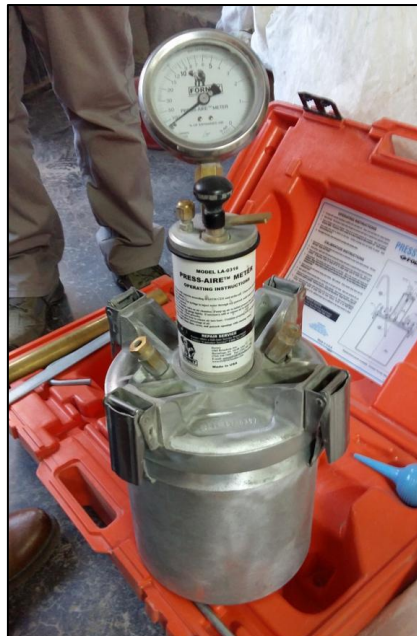
Figura 27: Olla Whashington para ensayo de contenido de aire en el concreto
