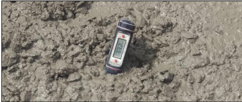
Figura 26: Medida de temperatura en el concreto con termómetro digital
