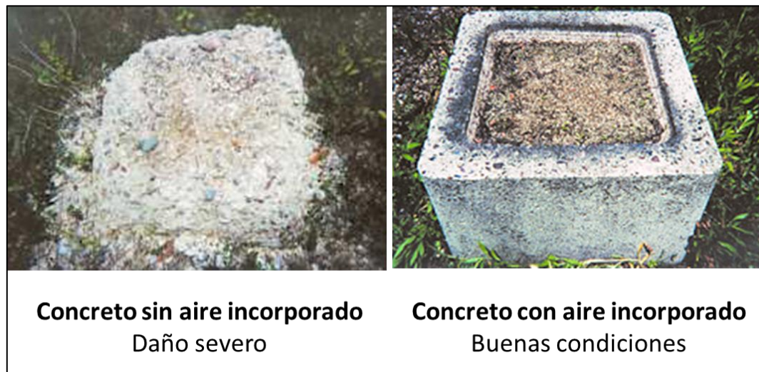
Figura 24: Pruebas de bloques de concreto después de 40 años de exposición a ciclos de hielo-deshielo (PCA)
