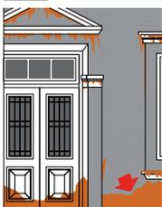
**Suciedad, salpicaduras de agua o presencia de sales, en la parte baja de los muros o zócalos.**
