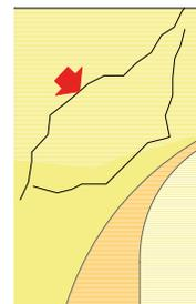
**Desprendimiento de la capa de pintura o revestimiento del cielo raso (par y nudillo) o intradós (bóveda) de la cubierta.**
