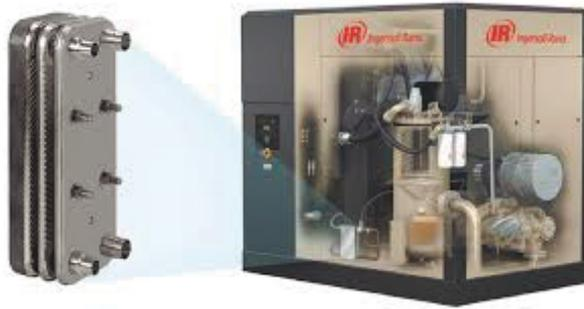
Ingersoll Rand ofrece para sus equipos el sistema ERS, que es un intercambiador de calor especialmente diseñado para transferir el calor de compresión capturado en el refrigerante al agua, que puede alcanzar temperaturas de hasta 70oC y usarse en las aplicaciones antes indicadas.
