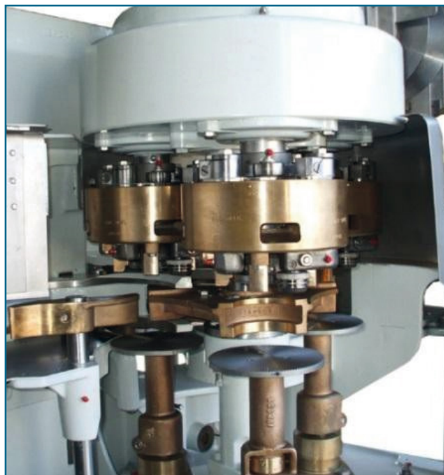
Figura N° 14. Vista de un evacuador generador de vacío
