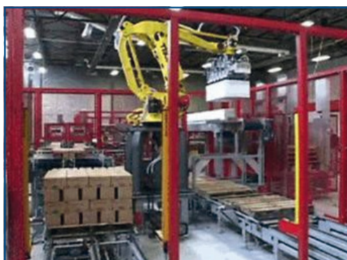
Figura N° 34. Paletizado automático con PLC y robot paletizador
