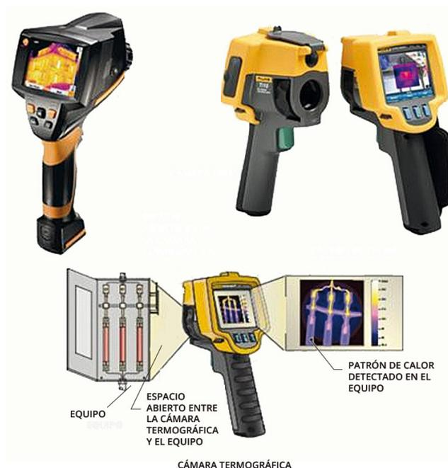
A partir de datos de las condiciones del entorno (humedad y temperatura del aire, distancia a objeto termografiado, ratio distancia a objeto/distancia focal del lente, temperatura reflejada, radiación incidente) y de las características de las superficies termografiadas como la emisividad la energía radiada detectada es convertida por la cámara termográfica en valores de temperaturas. En la termografía, cada pixel corresponde con un valor de medición de la radiación; con un valor de temperatura.
