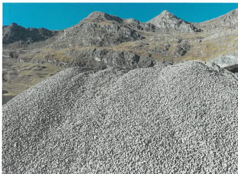
Inadecuado almacenamiento de agregados
