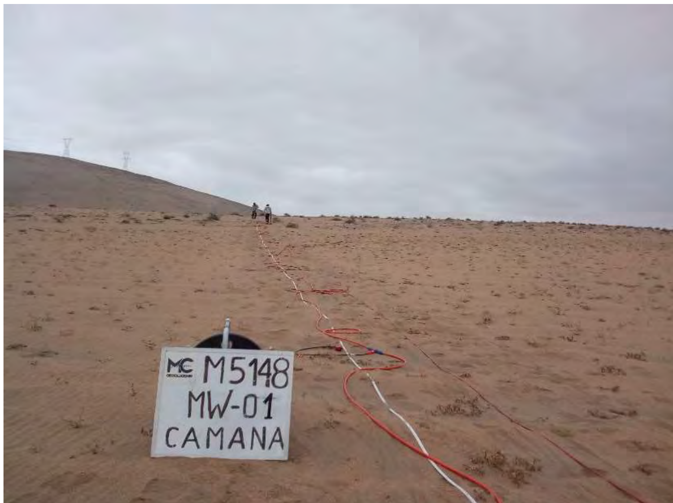
Foto 2: Ensayo Geofísico MASW-1
