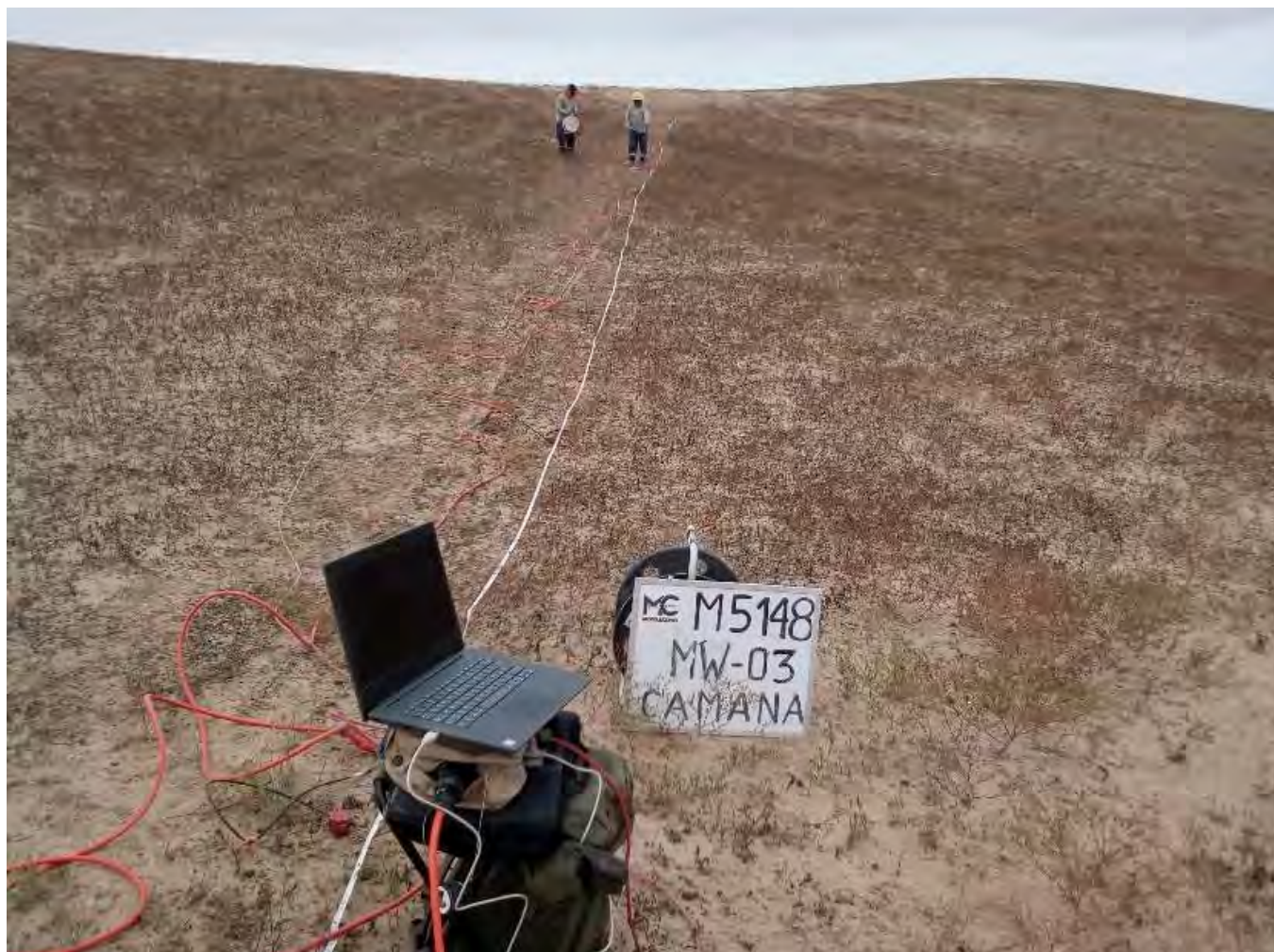
Foto 6: Ensayo Geofísico MASW-3
