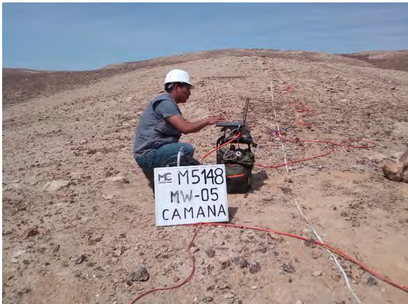
Foto 10: Ensayo Geofísico MASW-5
