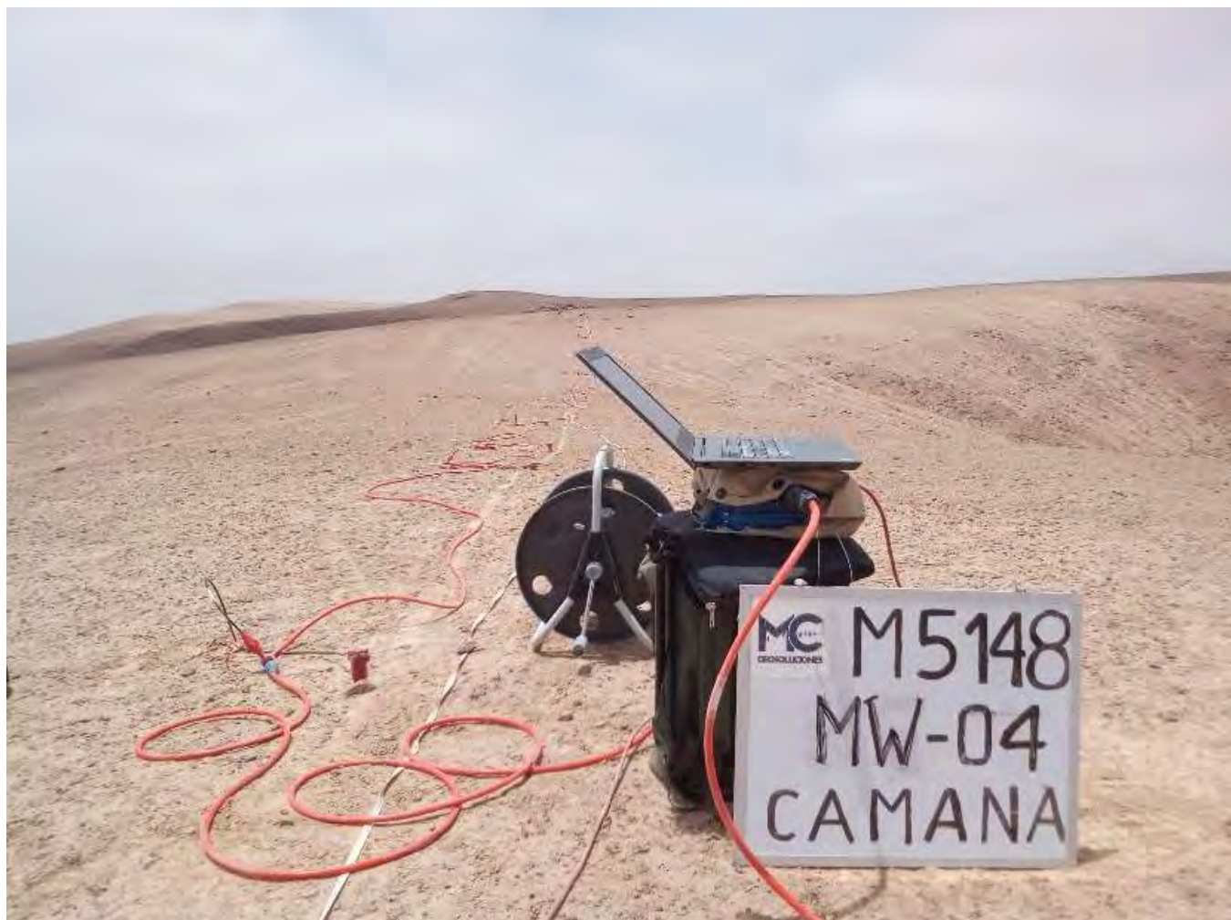
Foto 8: Ensayo Geofísico MASW-4
