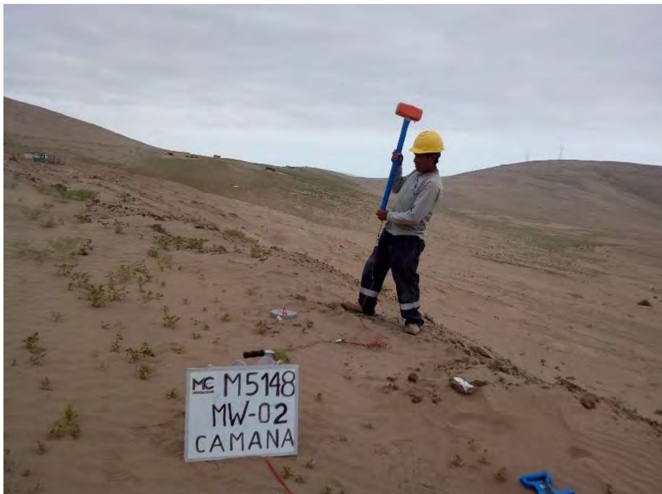
Foto 4: Ensayo Geofísico MASW-2
