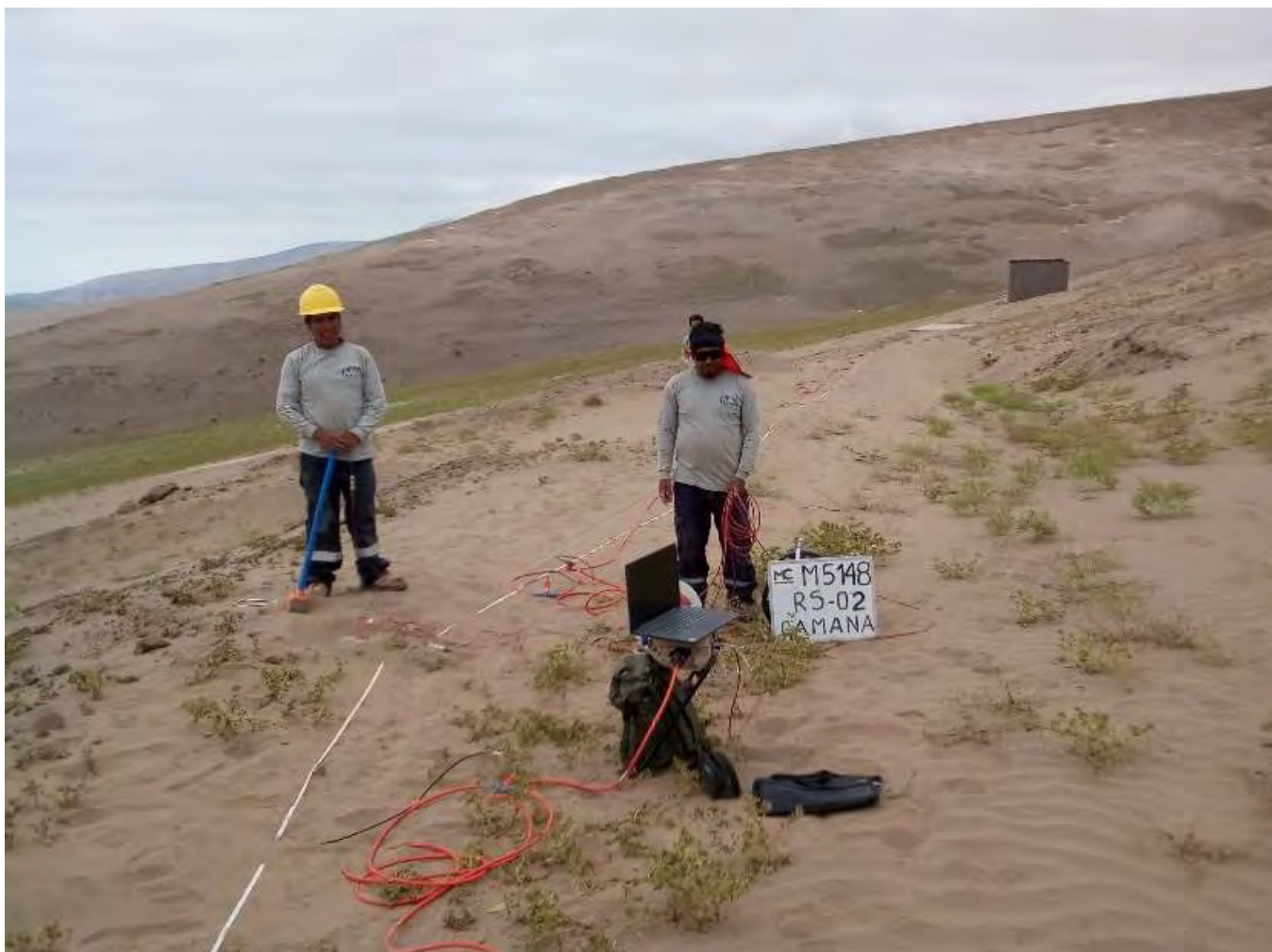
Foto 3: Ensayo Geofísico Refracción sísmica LS-2
