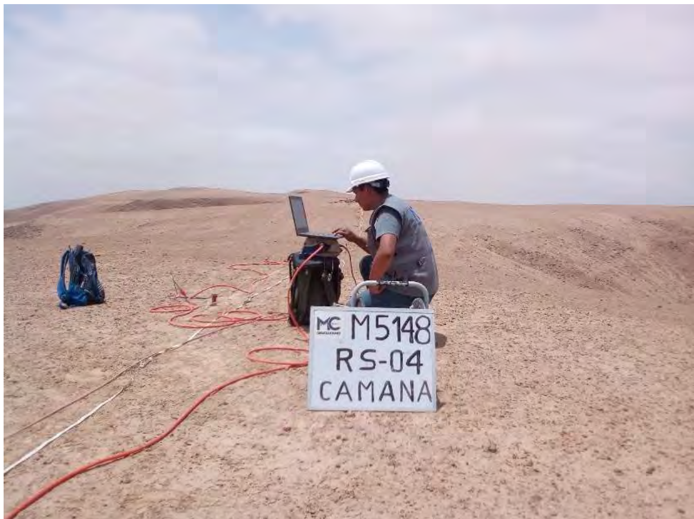
Foto 7: Ensayo Geofísico Refracción sísmica LS-4
