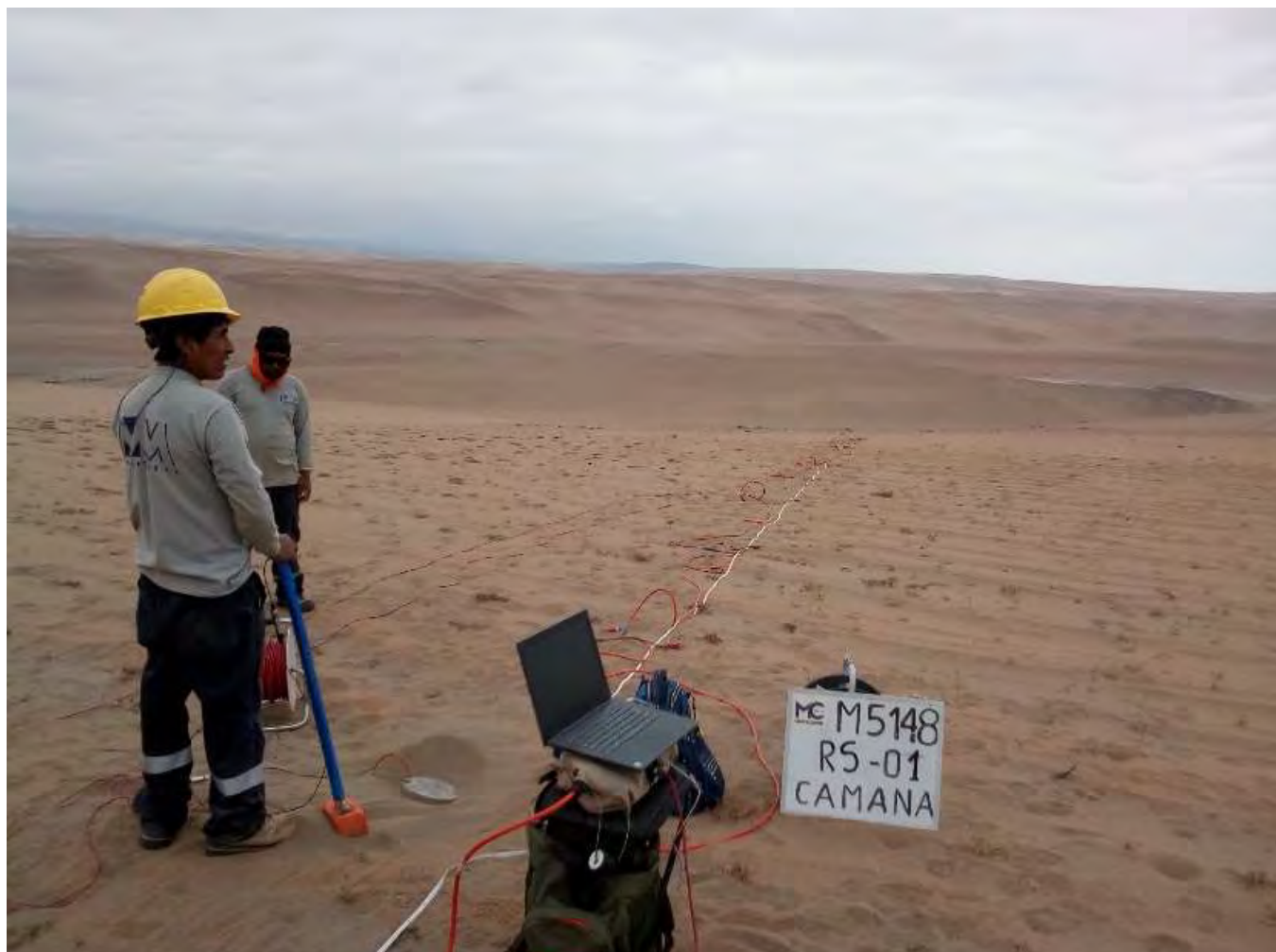
Foto 1: Ensayo Geofísico Refracción sísmica LS-1
