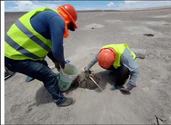
**Foto N° 13:** Adición de agua hasta 15 cm. después del periodo nocturno de saturación.
