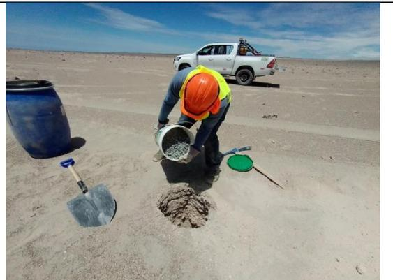
**Foto N° 04:** Adición de grava a la calicata 01 hasta un espesor de 5 cm.
