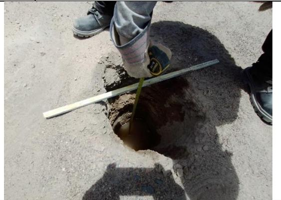
**Foto N° 06:** Medición del descenso del agua en los últimos 10 min.
