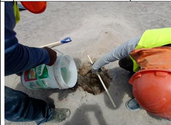
**Foto N° 17:** Adición de agua hasta 15 cm. después del periodo nocturno de saturación.
