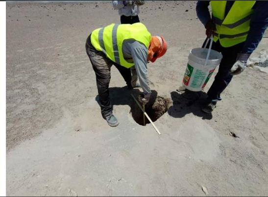
**Foto N° 14:** Medición del descenso del agua en los últimos 10 min.
