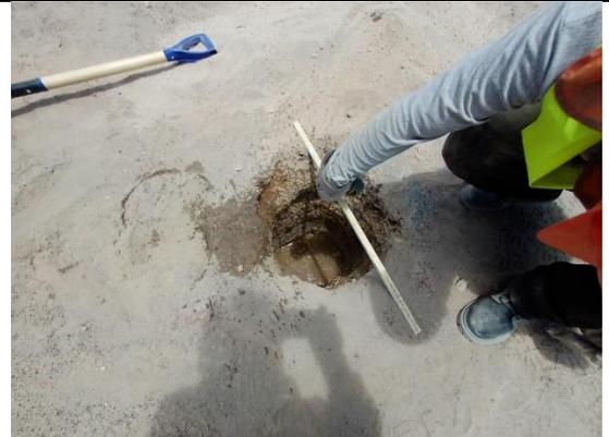
**Foto N° 10:** Medición del descenso del agua en los últimos 10 min.
