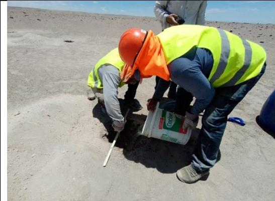
**Foto N° 09:** Adición de agua hasta 15 cm. después del periodo nocturno de saturación.
