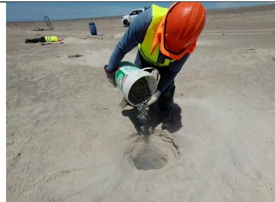
**Foto N° 16:** Adición de grava a la calicata 04 hasta un espesor de 5 cm.
