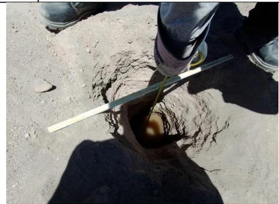
**Foto N° 18:** Medición del descenso del agua en los últimos 10 min.
