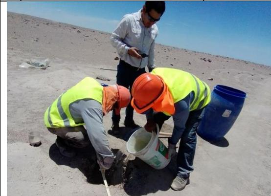
**Foto N° 05:** Adición de agua hasta 15 cm después del periodo nocturno de saturación.
