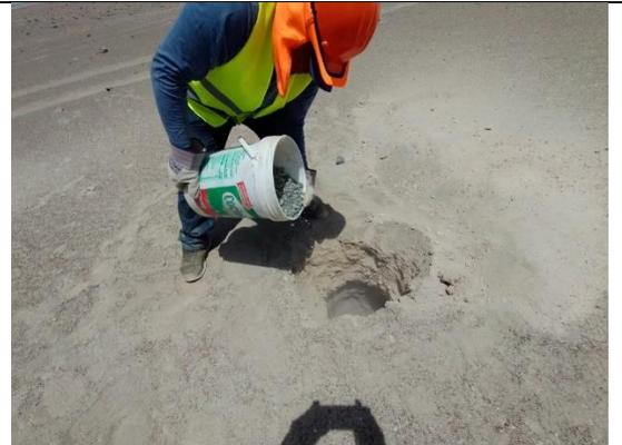
**Foto N° 08:** Adición de grava a la calicata 02 hasta un espesor de 5 cm.
