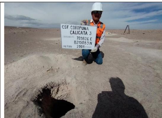
**Foto N° 11:** Excavación de la calicata 03 en superficie de 30cmx30cmx100cm de profundidad.
