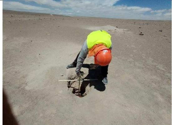
**Foto N° 26:** Medición del descenso del agua en los últimos 10 min.
