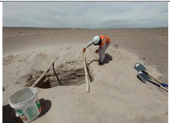
**Foto N° 28:** Medición de la calicata a profundidad
