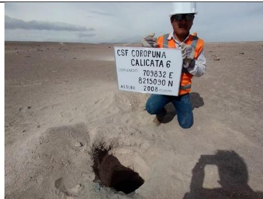
**Foto N° 23:** Excavación de la calicata 06 en superficie de 30cmx30cmx100cm de profundidad.
