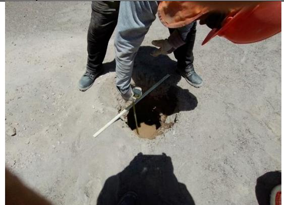
**Foto N° 22:** Medición del descenso del agua en los últimos 10 min.
