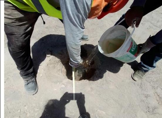
**Foto N° 25:** Adición de agua hasta 15 cm. después del periodo nocturno de saturación.
