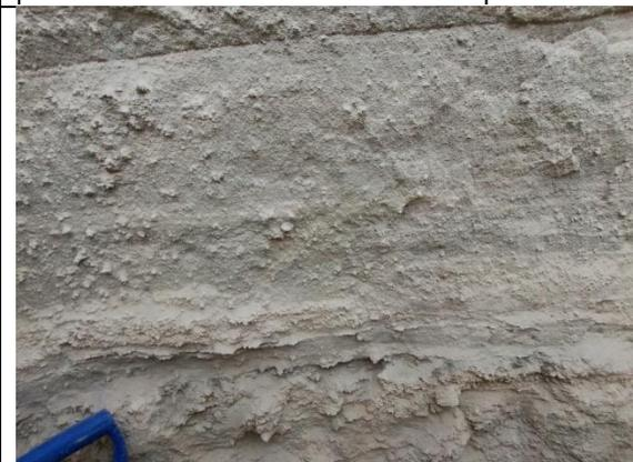
**Foto N° 29:** Se observa los estratos de la calicata de 4.5 m de profundidad.
