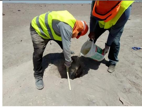
**Foto N° 21:** Adición de agua hasta 15 cm. después del periodo nocturno de saturación.
