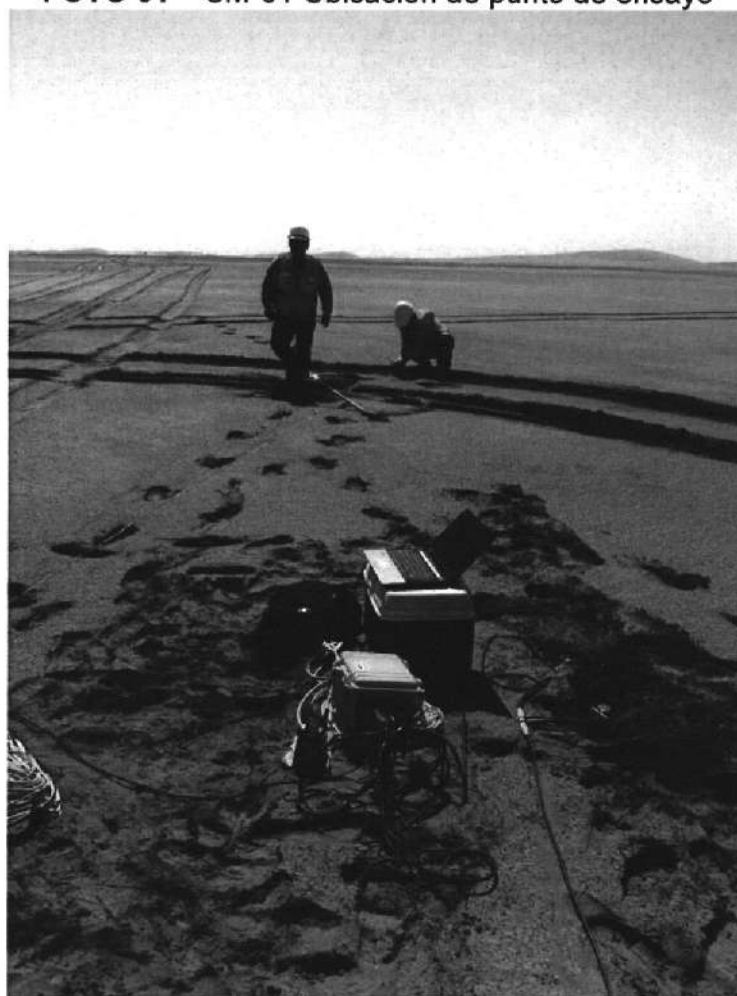
FOTO 02 SM-01 Tendido de cables sísmico
