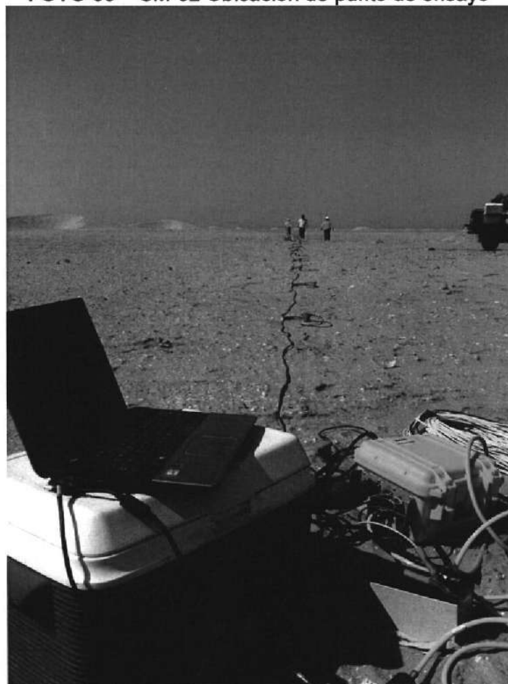
FOTO 04 SM-02 Tendido de cables sísmico
