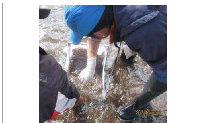
Foto N° MT-XIX- 03: Uso de la red Súber para extracción de Macroinvertebrados en río.
