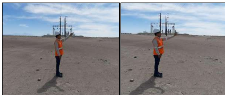
FOTO 1: MEDICIÓN DE LOS CAMPOS ELECTROMAGNÉTICOS EN LA PLANTA FOTOVOLTAICA MAJES SOLAR 20 TS
