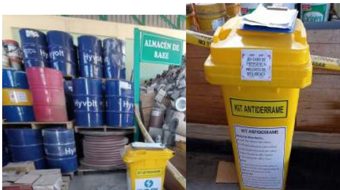
Fotografía N° 7: Kit de 20 galones ubicado en Almacén de Residuos Peligrosos y RRAEE.
