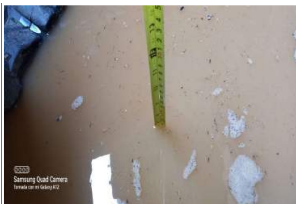
Foto N°5: Fin de la medición del descenso de agua para determinar la infiltración en el terreno.
