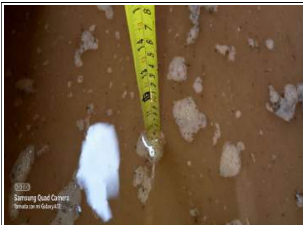
Foto N°4: Inicio a la medición del descenso de agua para determinar la infiltración en el terreno.
