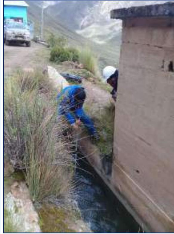
**Imagen 04:** Medición de caudal en agua turbinada - CH Yanahuin
