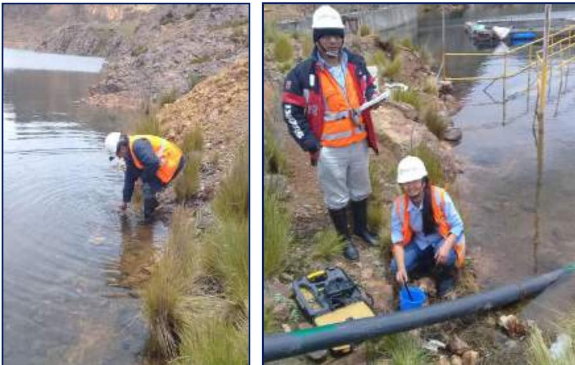
**Imagen 03:** Medición in situ (T°, Conductividad, OD y pH) - Compuerta Majada Piscopiana.
