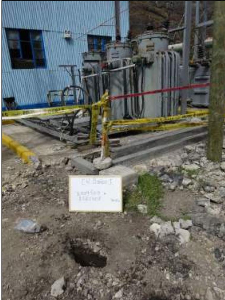
**Foto N° 2.** Ejecución de la calicata 6728-BII, ubicado al sur de la zona de transformadores.
