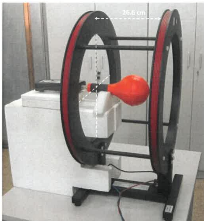
Figura 2: Montaje de calibración en el sistema de bobinas Helmholtz – Campo B
