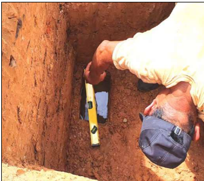
Foto 05.- Llenado y medición de nivel en la Calicata B-5
