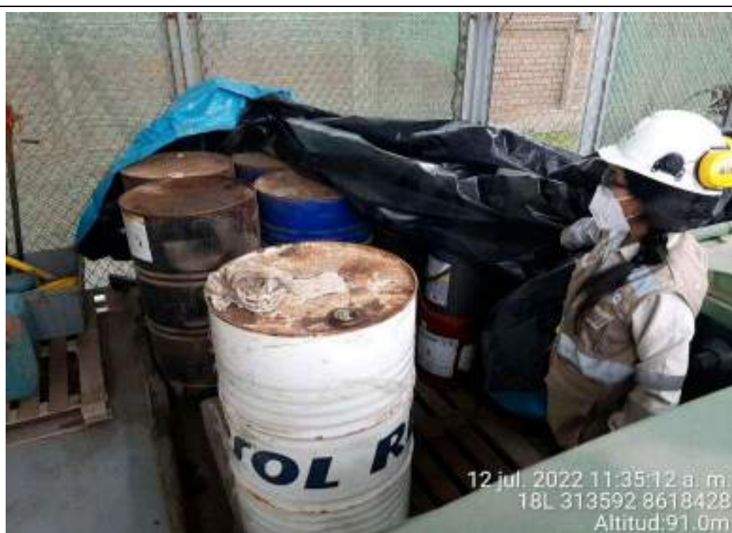
Fotografía N° 9: Interior del Almacén de Residuos Peligrosos de la C.T. Santo Domingo de Los Olleros. Se observan cilindros de residuo líquido peligroso al interior de una bandeja de madera con geomembrana.
