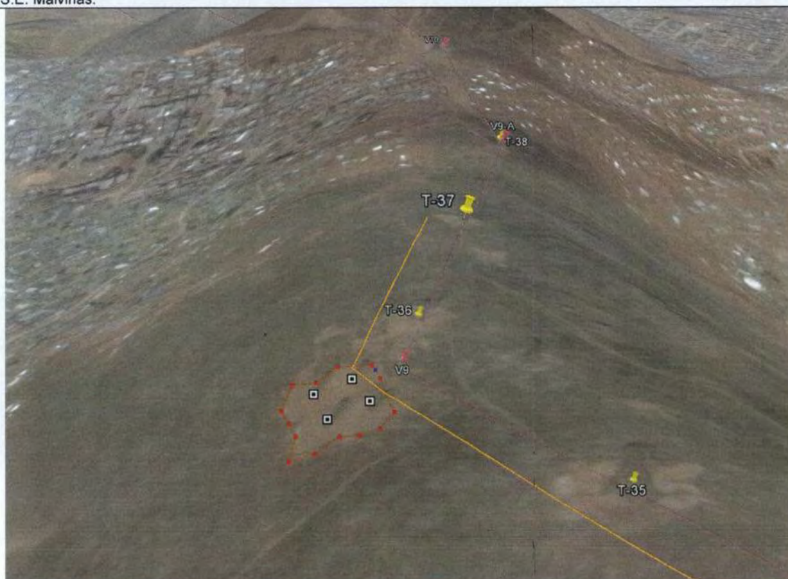
Fotografía N°8: Vista satelital del área disturbada (puntos rojos) del pósito de la L.T 220 kV S.E. Mirador - S.E. Malvinas (puntos blancos) el cual está instalado fuera de la franja de servidumbre (línea naranja).
