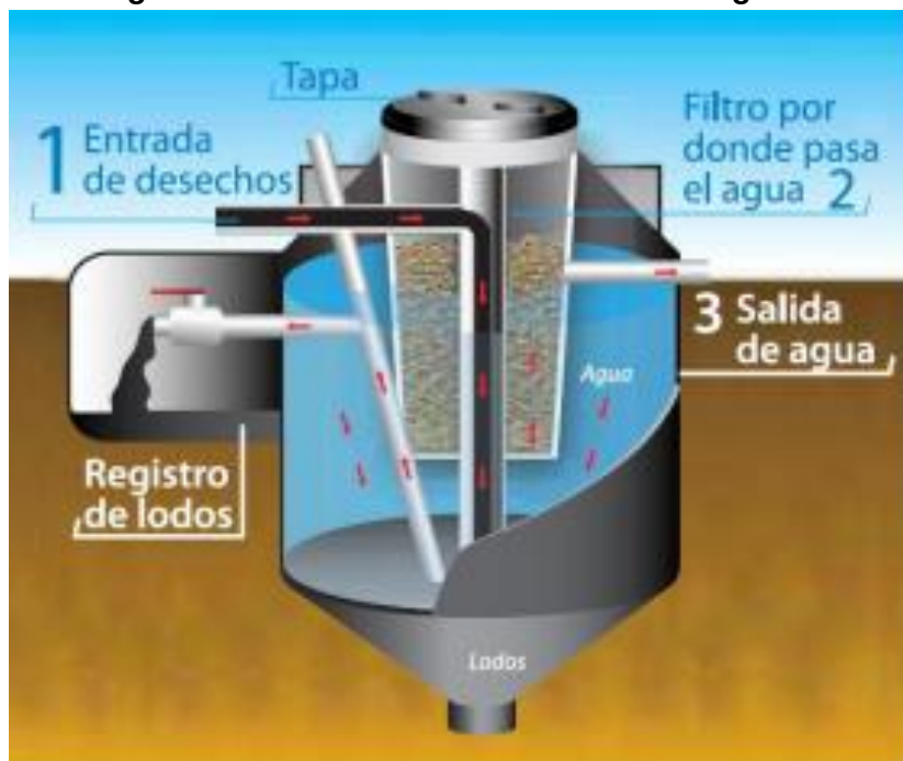
Figura 3.3.2-11. Funcionamiento del biodigestor
