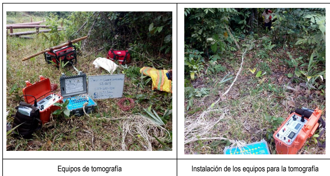
Fotografía 3-5 Instalación de los equipos de tomografía eléctrica
