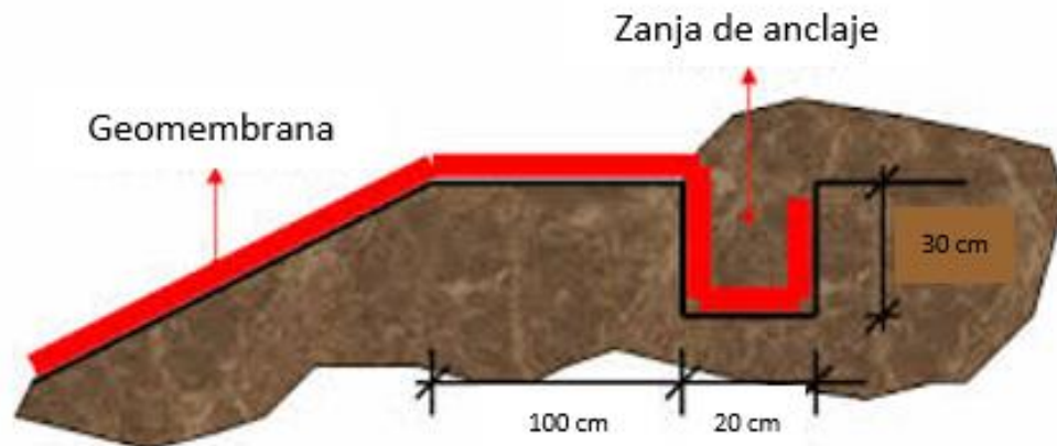
Figura 5-14 Configuración para la zanja de anclaje (instalación de geomembrana)
