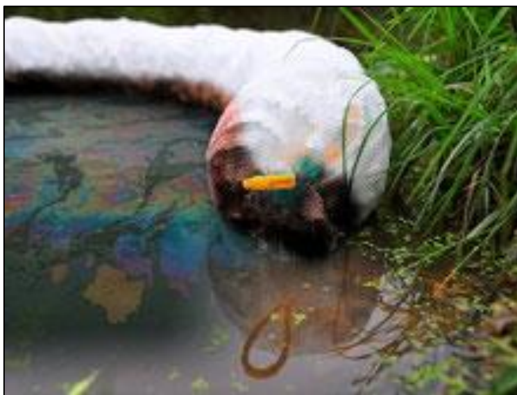
Fotografía 5-1 Barreras de contención de hidrocarburos (hidrofilicas)
