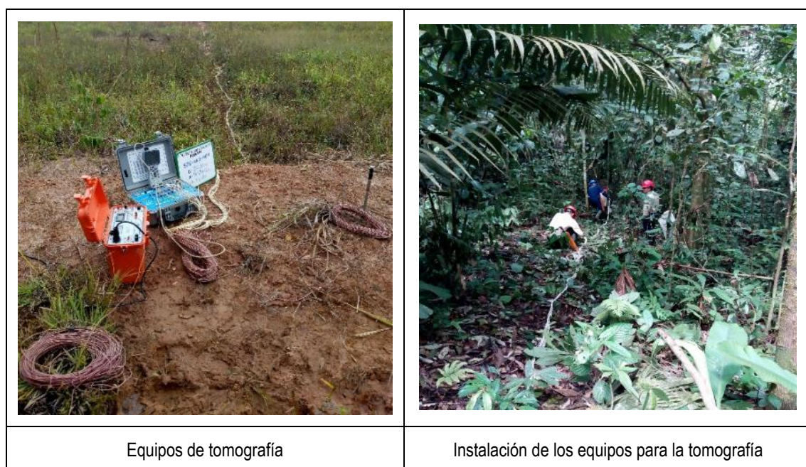
Fotografía 3-6 Instalación de los equipos de tomografía eléctrica
