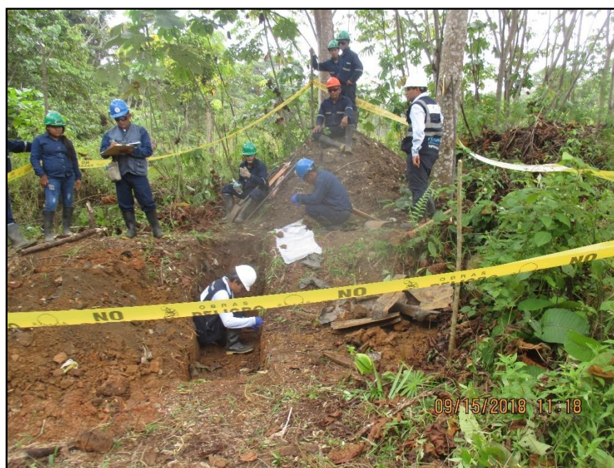
Fotografía 3-6. Muestreo de Suelo en Calicata
