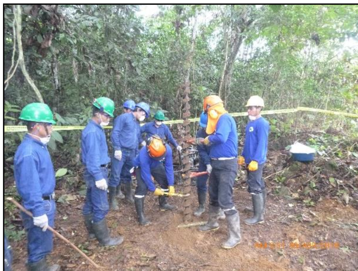
Fotografía 3-8. Perforación con Equipo Helicoidal
