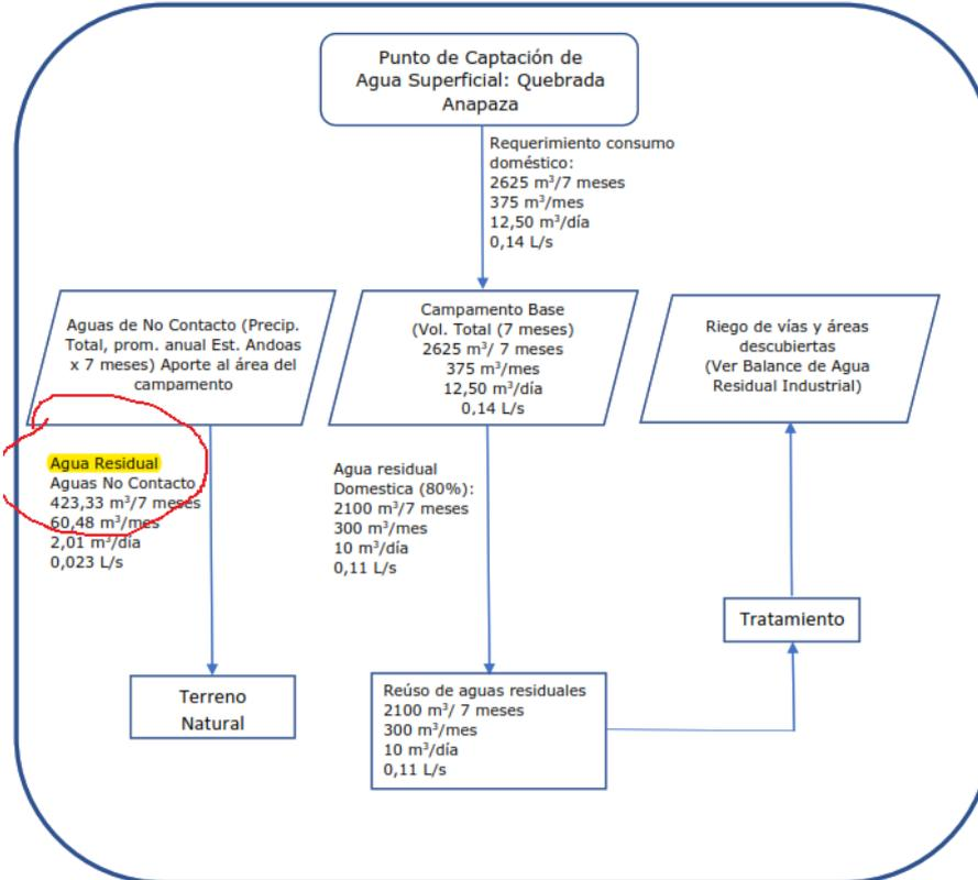
Figura 1. Diagrama de Flujo de Balance de agua Industrial S0100
