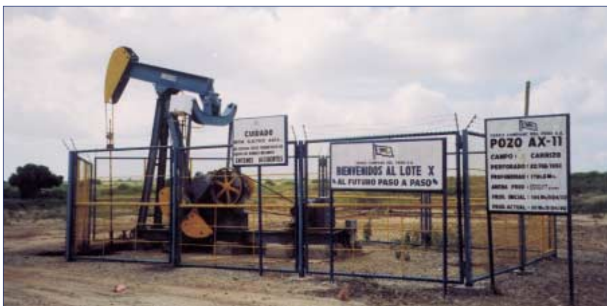
Unidad de Bombeo Mecánico - Noroeste Mechanical Pumping Unit - Northwest
