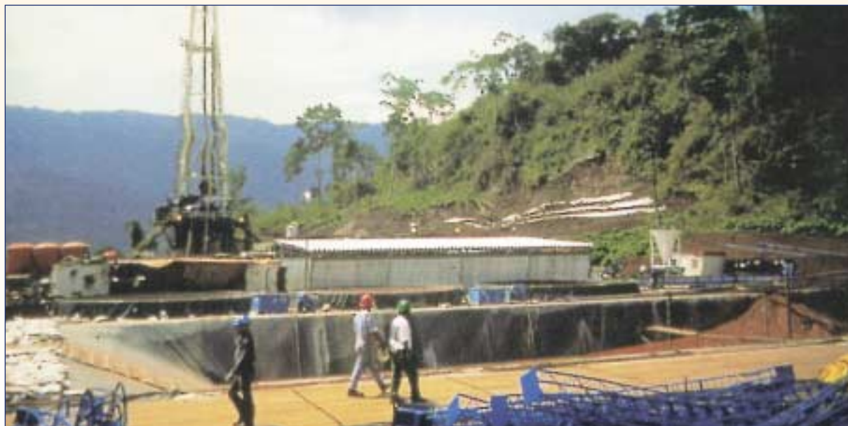
Vista que Muestra las Medidas de Protección al Suelo de los Cortes de Perforación - Selva Sur View Showing Protection Measures on Drilling Cutting Soil – Southern Jungle
