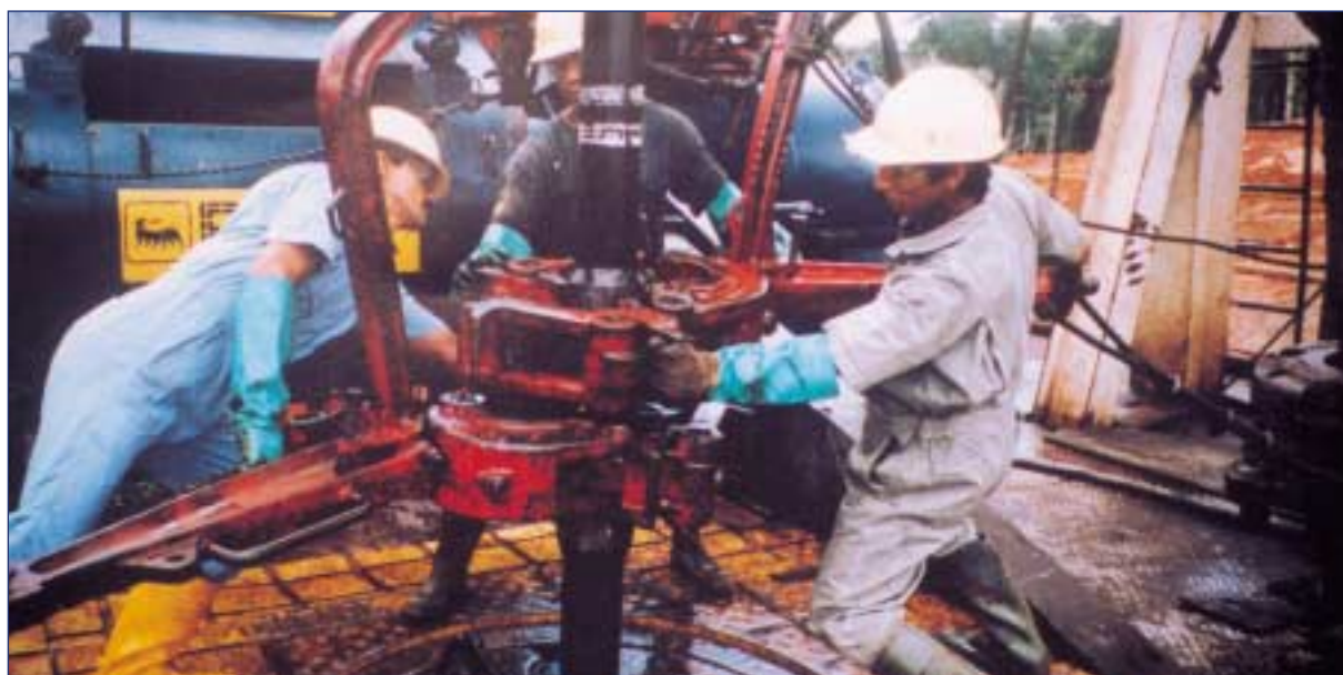
Obreros Sacando Tubería de Perforación - Selva Norte Workers Taking out Drilling Pipeline – Northern Jungle
