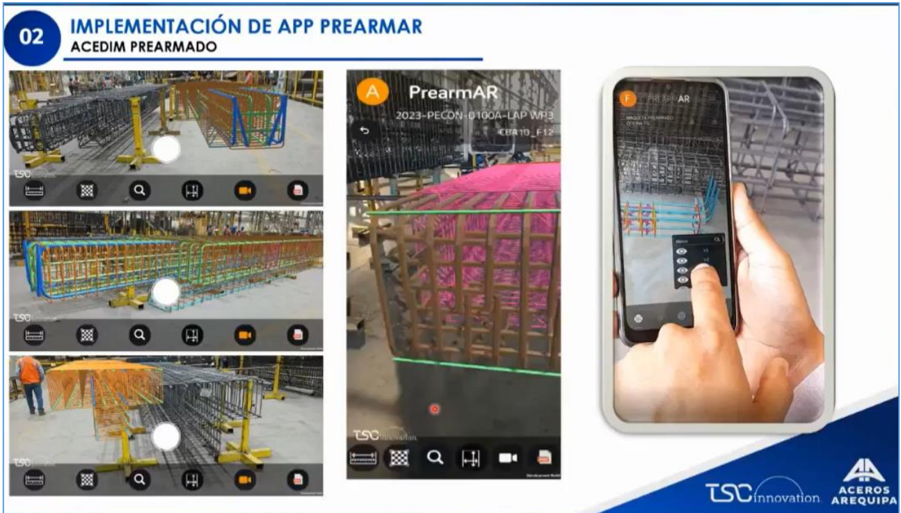
Figura 58. Implementación de app PrearmAR para inspección de estribos
