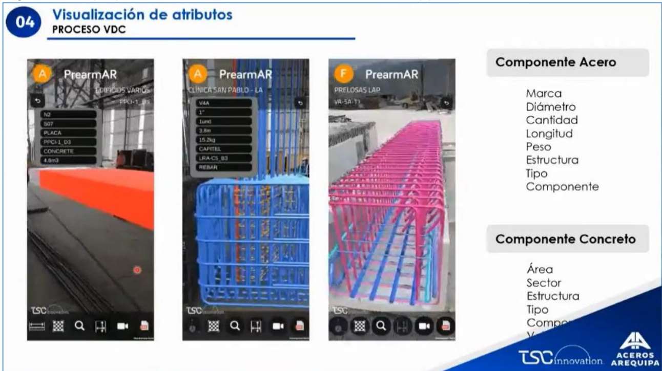
Figura 60. Superposición de información de armaduras de la app PrearmAR
