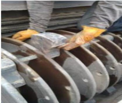
Mantenimiento de martillos de molino primario.
