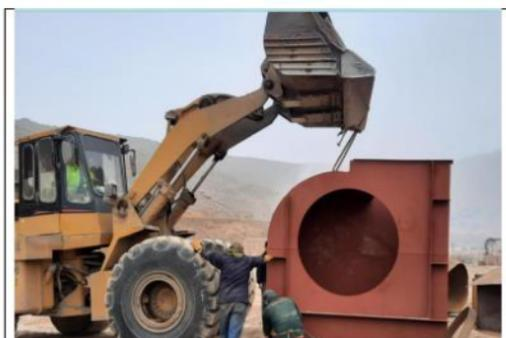
Fabricación de extractor para horno.
