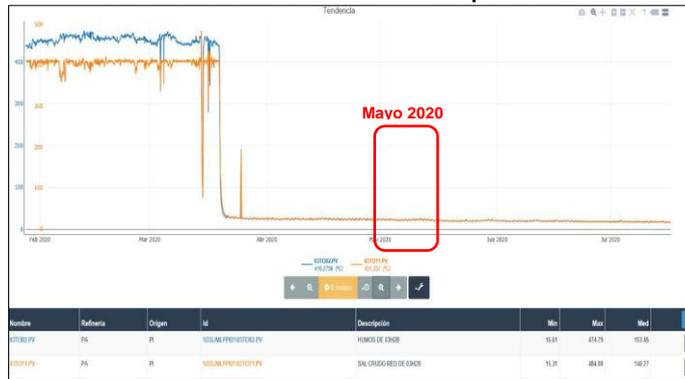
**Descripción:** El gráfico muestra que, el sistema PI data Link no detectó en el equipo denominado 03H2B temperatura a la salida de humos del horno hacia el ambiente, en tanto arrojó una línea –color azul– sin picos – temperatura (°C)– durante el mes de mayo de 2020.
