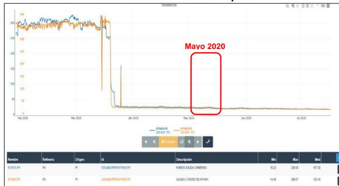
**Descripción:** El gráfico muestra que, el sistema PI data Link no detectó en el equipo denominado 01H101 temperatura a la salida de humos de la chimenea del horno hacia el ambiente, en tanto arrojó una línea –color azul– sin picos – temperatura (°C)– durante el mes de mayo de 2020.
