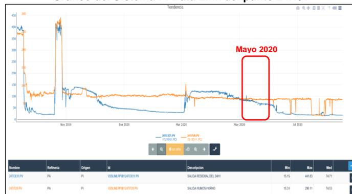
**Descripción:** El gráfico muestra temperatura a la salida de humos del horno hacia el ambiente, en un rango de 60°C a 70°C de temperatura; y, a la salida residual en un rango de 50°C a 70°C de temperatura, durante el periodo de mayo de 2020.
