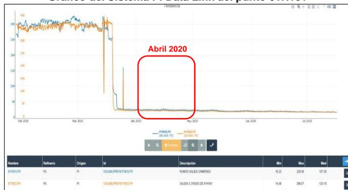
**Descripción:** El gráfico muestra que, el sistema PI data Link no detectó en el equipo denominado 01H101 temperaturas a la salida de humos de
