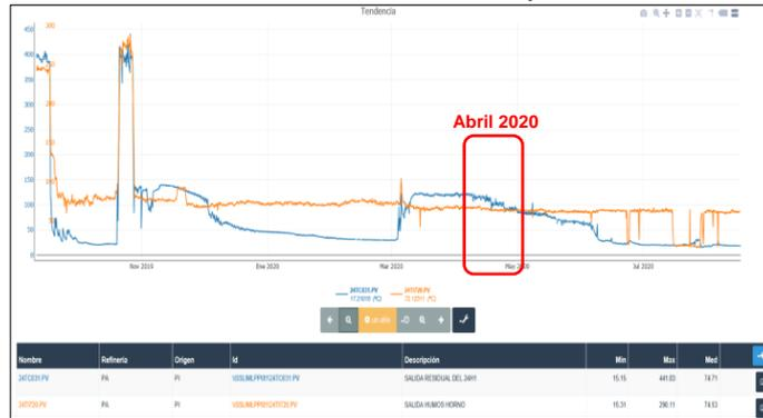
**Descripción:** El gráfico muestra temperatura a la salida de humos del horno hacia el ambiente, en un rango de 60°C a 70°C de temperatura; y, a la salida residual en un rango de 70°C a 80°C de temperatura, durante el periodo de abril de 2020.
