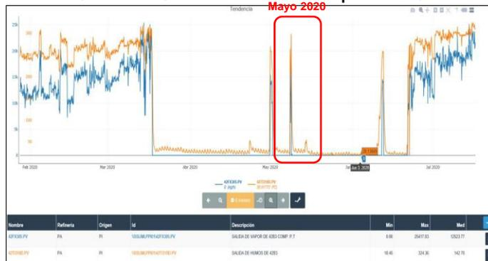
**Descripción:** El gráfico muestra que, el sistema PI data Link de mayo de 2020 en la mayor parte del mes de mayo del 2020 no detectó temperatura a la salida de humos hacia el ambiente y sólo detectó dos momentos puntuales con temperatura a la salida de humo del horno tipo acuo-tubular en el equipo denominado 42B3, en tanto, se observan dos picos no consecutivos con lecturas de temperatura(°C) en la línea –color anaranjado– de salida de humo del horno.
