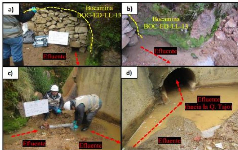
Esta acción desvirtúa el muestreo ambiental en este punto, dado que los resultados de muestreo se verían alterados por los elementos presentes en el suelo y no sería representativo del componente imputado.
