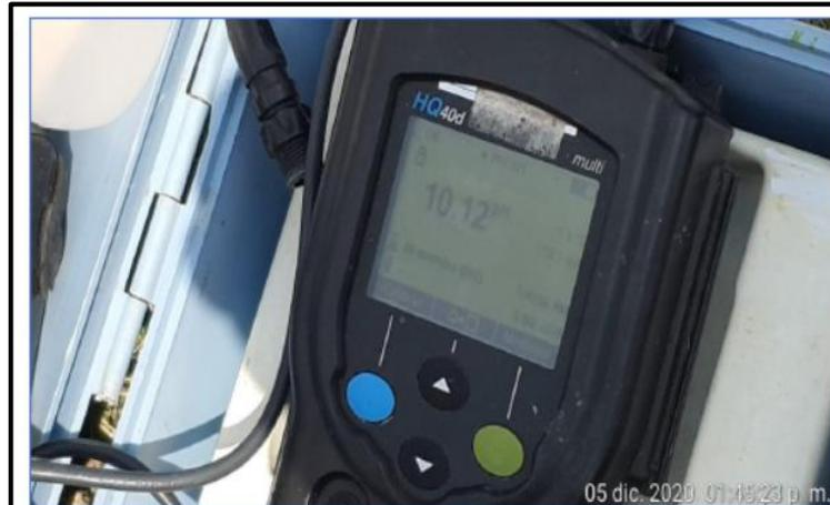
Fotografía N° 3: Resultado de la verificación con el buffer de pH 10. Se observa que el resultado obtenido es de 10,12 unidades de pH, existiendo una variación mayor al criterio de aceptación.
