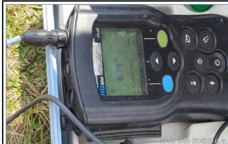
Fotografía N° 2: Resultado de la verificación con el buffer de pH 7. Se observa que el resultado obtenido es de 6,76 unidades de pH, existiendo una variación mayor al criterio de aceptación.
