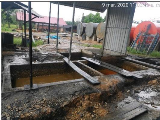
**Fotografía IMG\_037.** Vista de los tanques de decantación en serie, y centrífuga que conforman el proceso de clarificación, cuyas capacidades son 3m<sup>3</sup>, 5m<sup>3</sup> y 15m<sup>3</sup>, respectivamente
