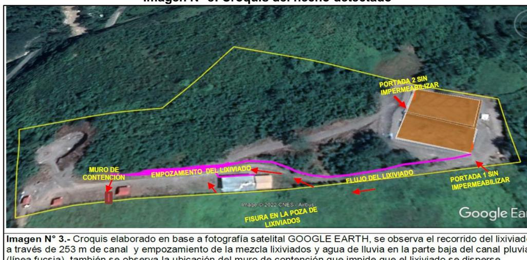
**Imagen N° 3.-** Croquis elaborado en base a fotografía satelital GOOGLE EARTH, se observa el recorrido del lixiviado a través de 253 m de canal y empozamiento de la mezcla lixiviados y agua de lluvia en la parte baja del canal pluvial (línea fucsia), también se observa la ubicación del muro de contención que impide que el lixiviado se disperse
