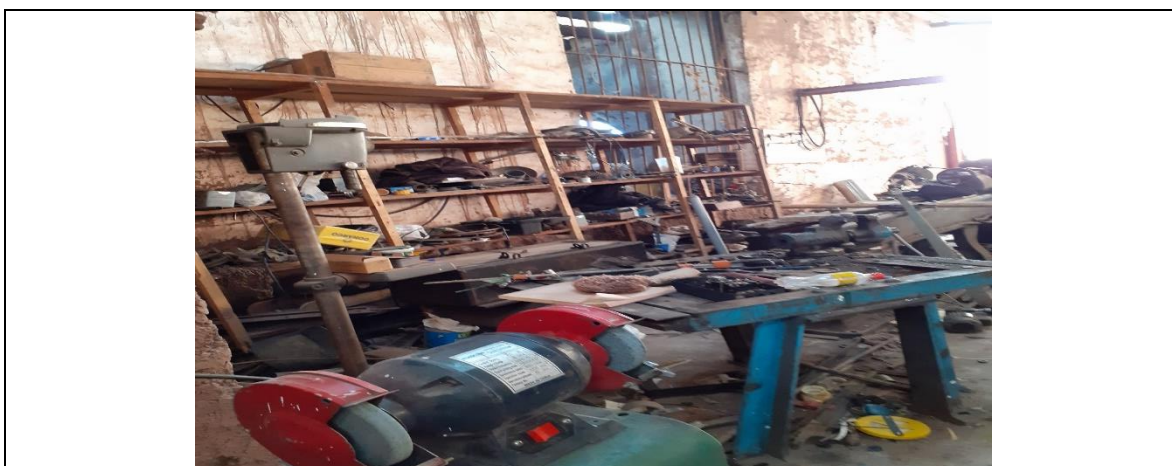
Fotografía N° 20190626_132426: Vista del área de mantenimiento donde se observaron piezas metálicas en desuso y trapos impregnados con grasa, sobre el piso de concreto sin contenedores ni señalización.
