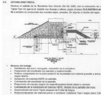
Figura N°27: Actividades ejecutadas de estabilidad física del componente Bocamina San Vicente Alto, informado a la autoridad mediante el Informe de Actividades de Cierre Primer Semestre Ejercicio 2012.
