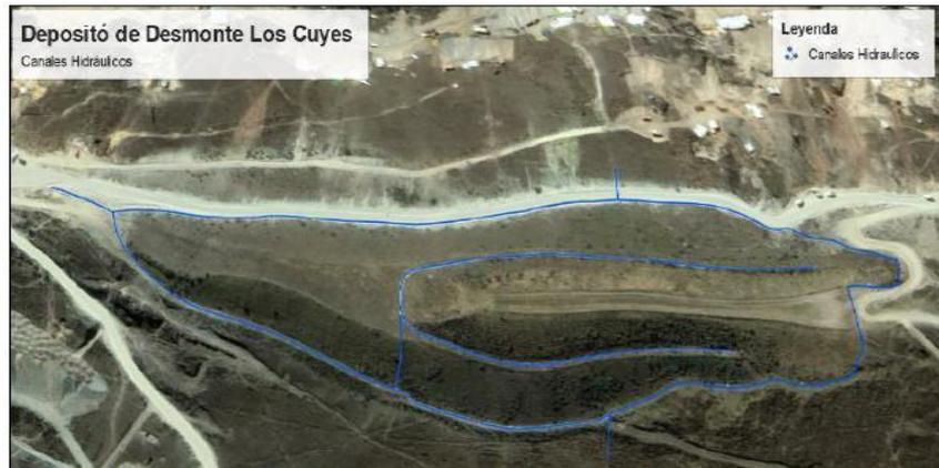
**Figura N° 42:** Vista del componente con los 03 canales para garantizar la estabilidad hidrológica del Depósito de Desmontes Los Cuyes Resolución Directoral N° 349-2014-MEM-DGAAM con fecha 08 de julio del 2014.
