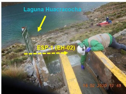
**Fotografía N° 30:** Vista de la toma de muestra del efluente denominado ESP-1 (EH-02), se aprecia que se ha realizado en el canal de concreto antes
