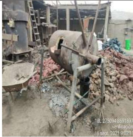
**Fotografía Timephoto-20210916-090211:** Se observa en el área próxima al Horno horizontal semi rotatorio N° 1 (aluminio) y Horno rotatorio N° 2 (hierro), el acopio de escoria de hierro y escoria de aluminio, sobre suelo natural y expuesto a la intemperie.
