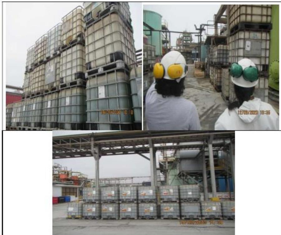
348. Como se aprecia en las vistas fotográficas, el material de descarte se encuentra debidamente rotulado, identificado y almacenado en tanques IBC's, que conforme a lo manifestado por el administrado una parte del material de descarte (ácido sulfúrico diluido al 72%) es utilizado en la producción de la Planta de Sulfato Férrico y otra parte es destinado a la venta; habiéndose generado entre enero de 2019 hasta agosto de 2020, un total de 1794 toneladas.
